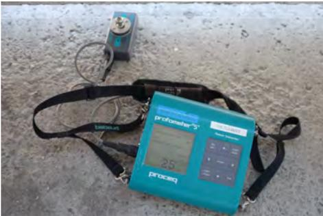
**Figure 3.5:** Cover meter PROFOMETER 5+ Model S.
